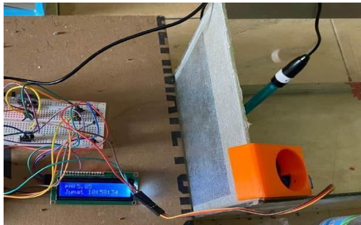
Gambar 11. Pengujian Sensor pH (Sumber: Farhan Hanif, 2025)
