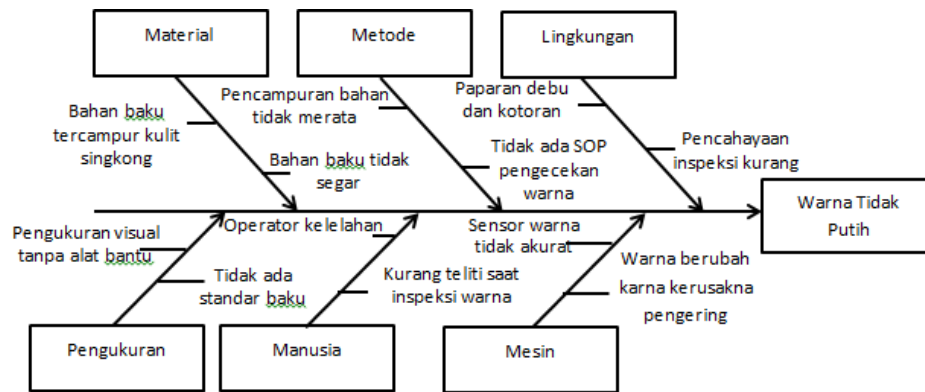
Gambar 6. Diagram Fishbone Cacat Warna Tidak Putih
