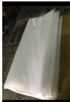
Gambar. 3. Plastik Inner Dengan Ketebalan 0,5 mm Dan 0,8 mm
