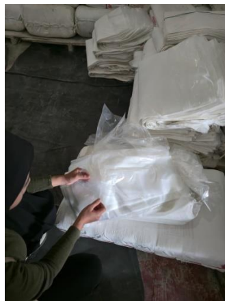
Gambar. 3. Plastik Inner Dengan Ketebalan 0,5 mm Dan 0,8 mm
